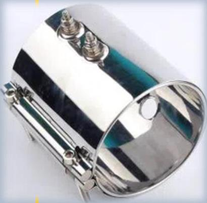
El espesor de la mica es cuidadosamente controlado para tener un balance entre características dieléctricas apropiadas y facilitar la transferencia de energía desde el núcleo hacia el proceso, el elemento calculado especialmente para brindar la capacidad requerida y una cubierta metálica de acero inoxidable y éste misto tratamiento térmico, para darle una protección y larga vida de la resistencia.
